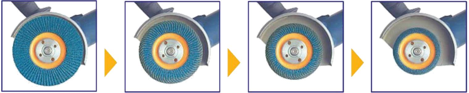
Der Trägerteller aus Spezialkunststoff lässt sich durch spanendes Trimmen im Durchmesser reduzieren und ermöglicht die Abnutzung des Schleifbelages bis zum restlosen Verbrauch. Die leicht schräg aufgebrachtene Schleiflamellen sorgen für einen optimalen, universalen Schleifwinkel. Der vibrationsstabile Trägerteller ist elastisch und geräuschkämpfend.
