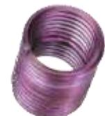
Mehrere Windungen sind polygonförmig, was klemmend auf die eingedrehte Schraube wirkt und diese somit sichert. Ihr Einsatz ist deshalb bei Anwendungen, die zyklischen Schwingungen oder Stoßwirkungen ausgesetzt sind, besonders vorteilhaft. Die Klemmwirkung bleibt auch bei wiederholten Einsätzen erhalten. Screw Locking Gewindeeinsätze sind leicht an ihrer Rotfärbung zu erkennen.
