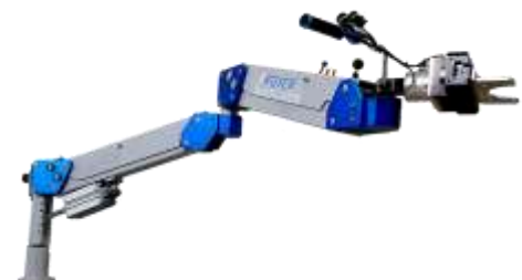
ROVER RM02 Für Lasten bis 50 kg Reichweite 1685 mm
