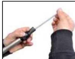
Das Nietdorn mit den magazinierten Blindnieten wird in das Werkzeug eingespannt.
