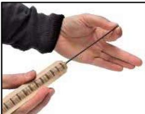
Magazinierte Blindniete werden in Papierbögen geliefert. So können diese leicht auf den Nietdorn aufgebracht werden
