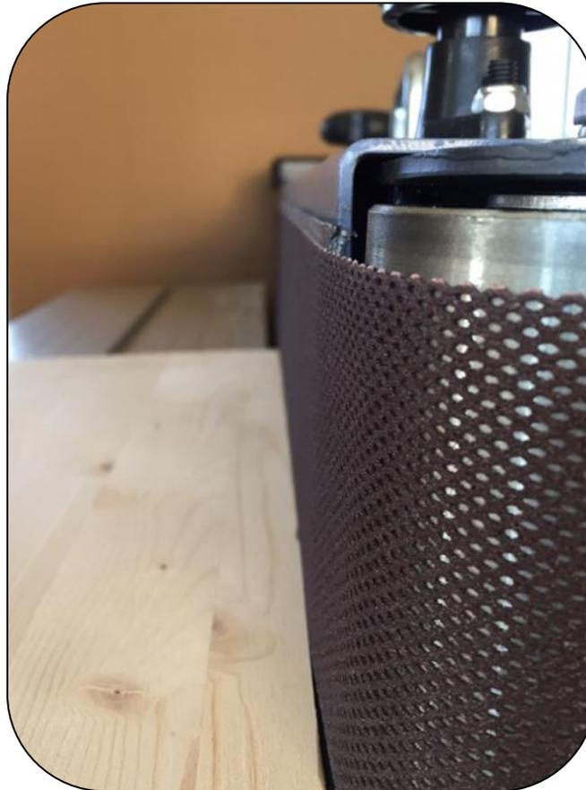
**Gitterschleifband zum effizienten Schleifen von Kanten und Flächen**
