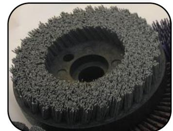
Schleifbürsten mit Schleifgewebebesatz stehen in einer Vielzahl an Konfigurationen zur Verfügung. Von weichen Geweben, die sich an Werkstücke mit kleinen Aussparungen und Bohrungen anpassen können, bis zu besonders harten Geweben, die das Schleifkorn sehr stark an das Werkstück pressen können und starke Kantenverrundung erzielen, kann jede Kundenanforderung erfüllt werden.
