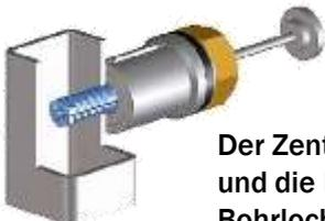
Der Zentrierdorn wird zurückgezogen und die Räumnadel wird in das Bohrloch eingeführt.
