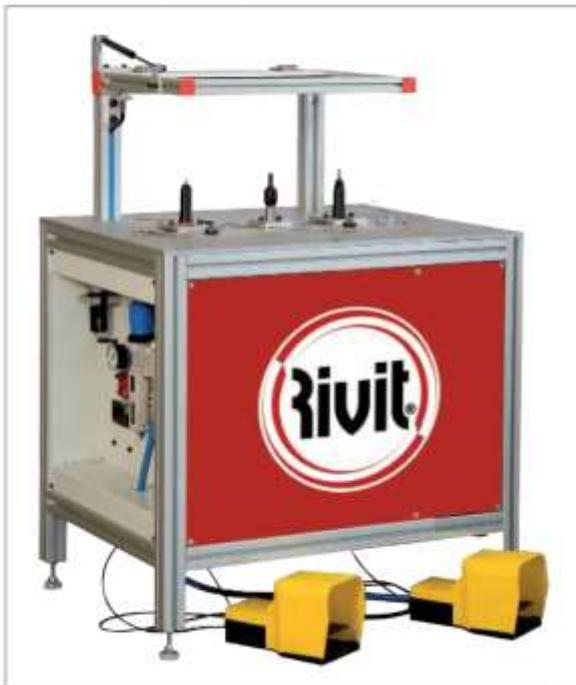
Die Module sind darauf ausgelegt, in automatisierten Produktionslinien eingesetzt zu werden. Weil Sie hydropneumatisch arbeiten, müssen sie mit Öl und Druckluft versorgt werden. Es wird außerdem eine Steuereinheit benötigt.
