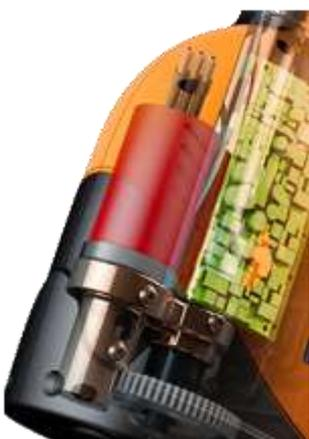
Der Hydraulikkreislauf wird von einer internen Elektronik gesteuert und wurde für hohe Belastungen ausgelegt. Die individuell für jedes Werkzeug durchgeführte Kalibrierung führt zu einer hohen Präzision und Reproduzierbarkeit der Setzvorgänge. Die beiden bürstenlosen Motoren sind besonders reibungsarm konzipiert, um den Energieverbrauch zu verringern.
