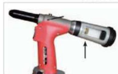
Drehregler zum Anpassen der Absaugung.
