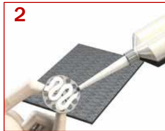
2 Aufbringen des Klebstoffes auf die MASTER-PLATE®
