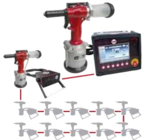
Bis zu 11 Werkzeuge mit Slave Einheit können mit einem Werkzeug mit Mastereinheit zu einem Netzwerk kombiniert und gleichzeitig verwaltet werden.
