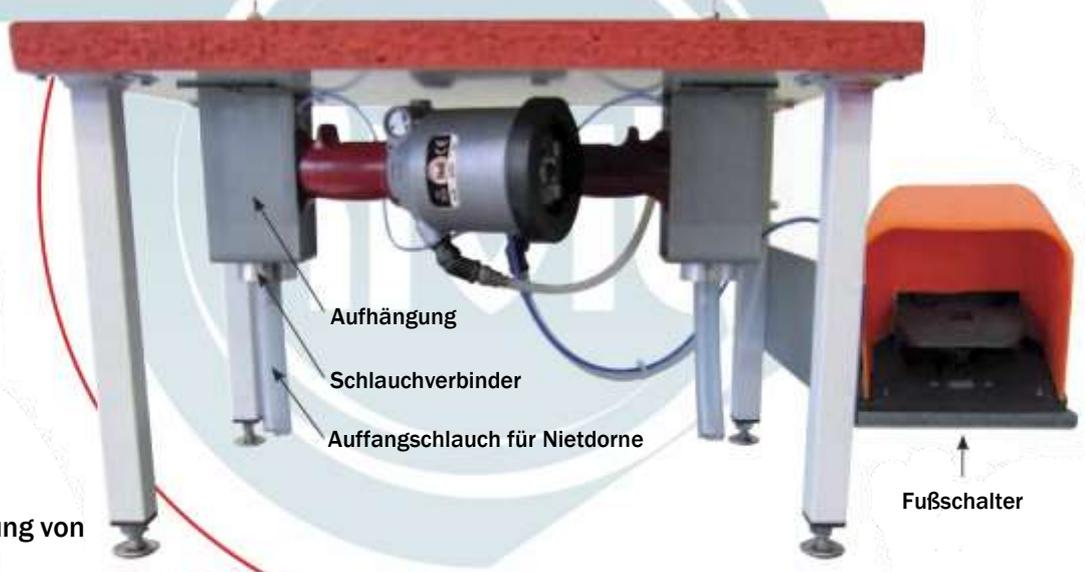
Zur Verarbeitung von Standard- und Strukturblindniete und Schließringbolzen
