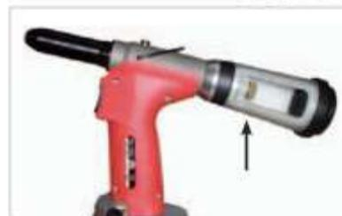
Drehregler zum Anpassen der Absaugung.
